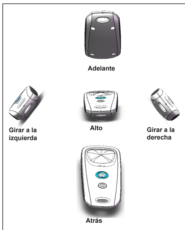
Figura 21. Comandos direccionales del control remoto
