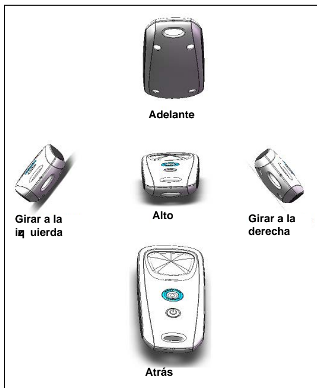
Figura 21. Comandos direccionales del control remoto
